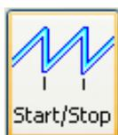
**Tipo di programmazione: Start / Stop (rampa ciclica):** TEACH IN, permette l'impostazione dell'encoder direttamente a partire dalla corsa fisica della specifica applicazione che si vuole misurare; la corsa è definita in una rampa che è poi ripetuta in una sequenza ciclica: quando si raggiunge la posizione finale della corsa (valore massimo del range di uscita), la posizione successiva corrisponderà al valore minimo dando così inizio a una nuova rampa, si veda a pagina 43.
